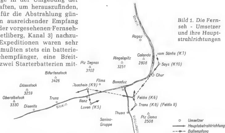
Bild 1. Die Fernseh-Umsetzer und ihre Hauptabstrahlrichtungen
